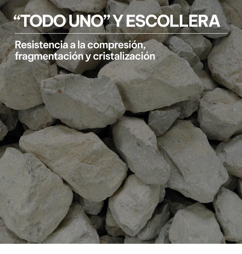
El "todo uno" o núcleo, procede de una voladura de cantera con un tamaño que oscila entre 0 y 300 Kg.
